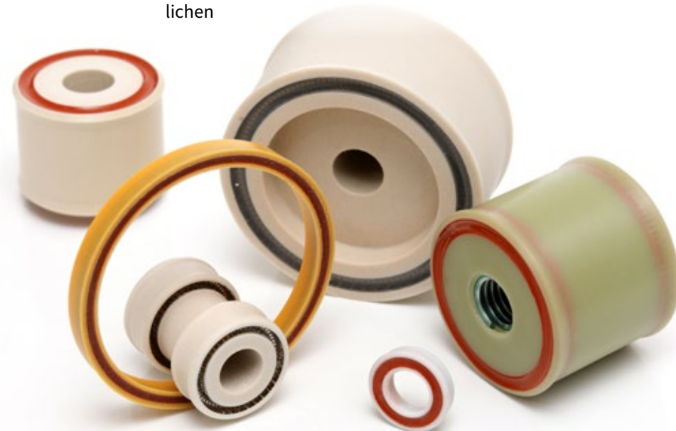
Sonderlösung Manschette: Dichtungssystem bestehend aus mehreren Teilen wie eine federelastische Dichtung und Stützringen um eine Abdichtung bei sehr hohen Drücken von über 1000 bar zu ermöglichen
