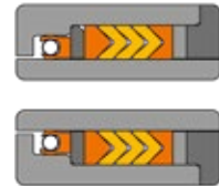
Sonderlösung Manschette: Dichtungssystem bestehend aus mehreren Teilen wie eine federelastische Dichtung und Stützringen um eine Abdichtung bei sehr hohen Drücken von über 1000 bar zu ermöglichen
