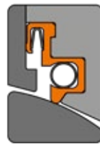
Klappendichtung mit mehreren angefederten Dichtlippen, beispielsweise einmal gegen die Klappe und einmal gegen das Gehäuse
