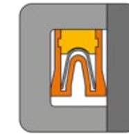
Typische Anordnung Kugelhahn: quasistatische Abdichtung hinter dem Sitzring
