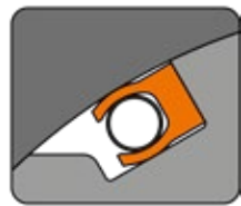
Kugelhahnabdichtung: gepipptes Dichtungsprofil in die Kugel integriert
